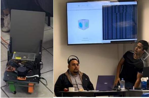
Fig. 18a) Plataforma robótica en impresión 3D neuro controlada con la Diadema EMOTIV EPOC X, b) entrenamiento del cubo y acciones de operación neuronal.
