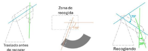
Figura 4: Grados de libertad de cada articulación del brazo
