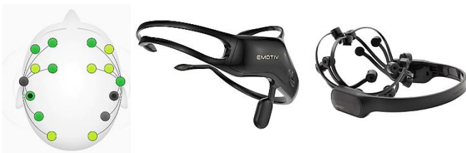
Fig. 8. a) Ubicación de los sensores Bajo un sistema internacional 10-20, b) Diadema Emotiv Insight de 5 electrodos, c) Diadema Emotiv EPOC X de 14 electrodos
