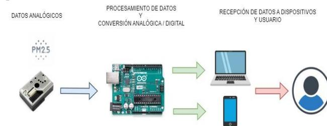
1. **Datos analógicos:** Los datos analógicos se refieren al mundo real, como puede ser luz, sonido, temperatura, presión, aire etc. Para el caso específico de este proyecto, los datos analógicos son PM2.5 las cuáles son captadas por el sensor óptico.
