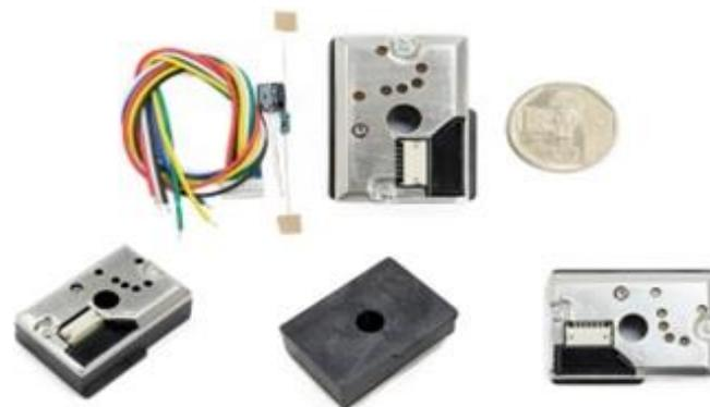
Figura 4: Vista a detalle del sensor modelo GP2Y1010AU0F
