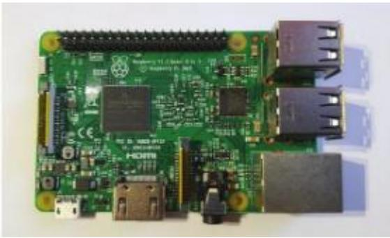
Figura 7. Raspberry Pi 3 Modelo B
