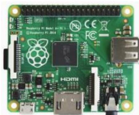
Figura 4. Placa Raspberry Pi 1 Modelo A+
