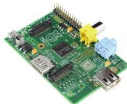
Figura 2. Placa Raspberry Pi 1 Modelo A
