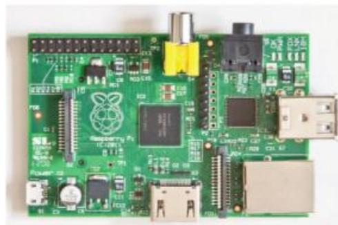
Figura 1. Placa Raspberry Pi 1 Modelo B
