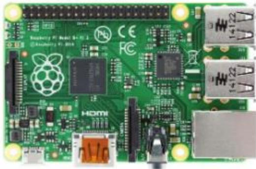
Figura 3. Placa Raspberry Pi 1 Modelo B+
