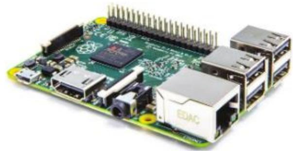
Figura 5. Placa Raspberry Pi 2 Modelo B
