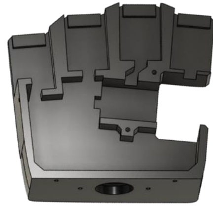
Figura 9: Diseño CAD de palma.
