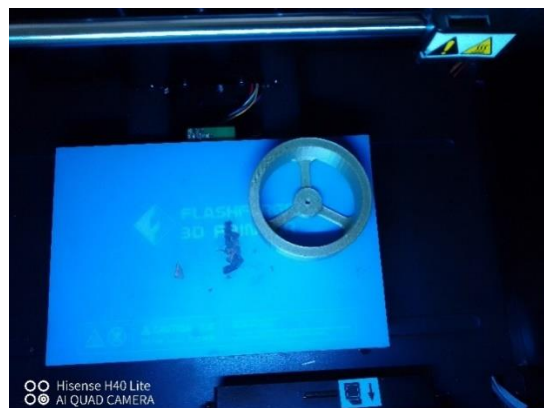
Figura 2: Impresión del volante de inercia en la impresora Flashforge.
