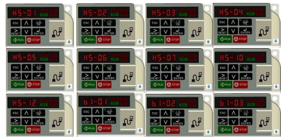
Figura 9 - Parámetros de comunicación del simulador Yaskawa V1000 ®.
