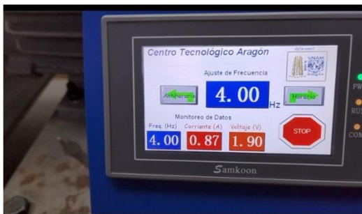
Figura 15 - Valores recabados en el HMI.
