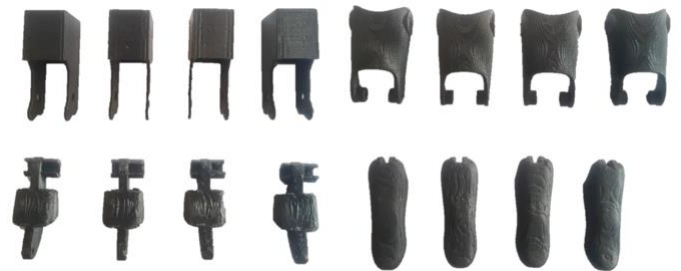
Figura 17: Impresión 3D, material PLA, de Falanges de la mano.
