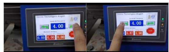
Figura 12 - Configuración del sentido de giro.
