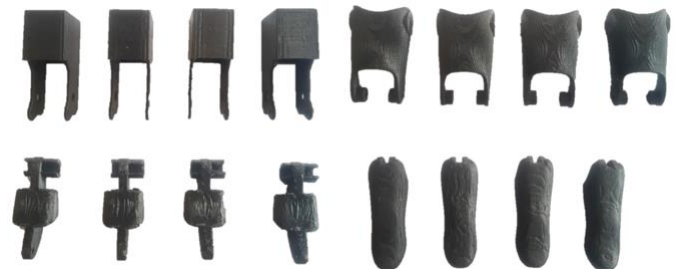
Figura 17: Impresión 3D, material PLA, de Falanges de la mano.
