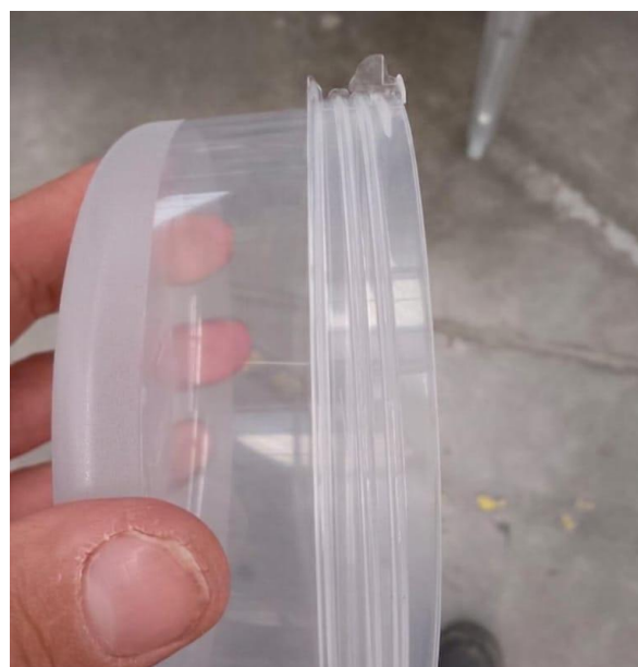
Figura 2: Presencia de exceso de material ( flash ).
