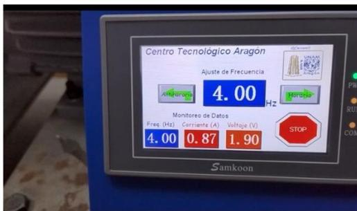
Figura 15 - Valores recabados en el HMI.
