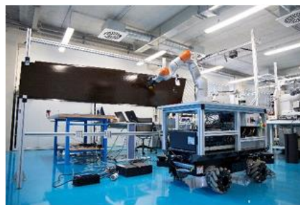
Inspección avanzada de piezas compuestas complejas.
