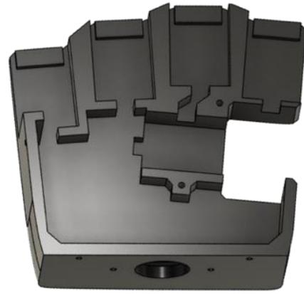
Figura 9: Diseño CAD de palma.
