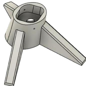
Figura 11: Diseño CAD de base para mano robótica.
