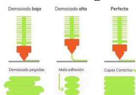
Fig. 10. Extrusión del filamento [14].
